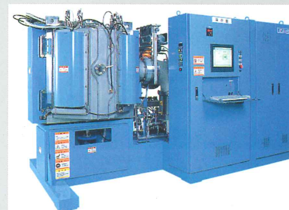
UBMS + AIP処理装置
